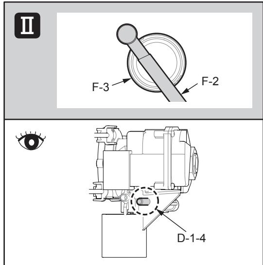
要求：请将软管 (F-2) 插入正确的位置。
